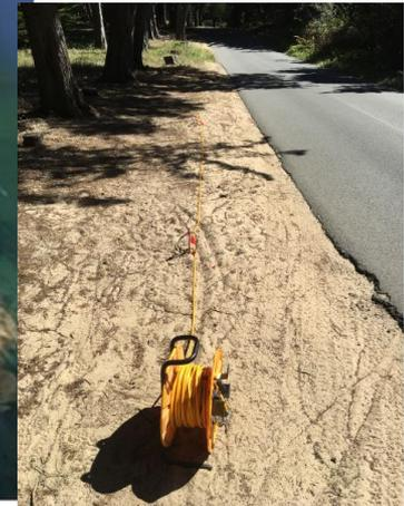
**Investigations : 23 profils électriques (entre 125 m et 475 m de long et max 40 m de profondeur) répartis sur 8 sites**
